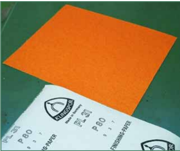
Achteraan het schuurpapier vind je de vermelding van de korrelgrootte. Bron: Wikipedia
