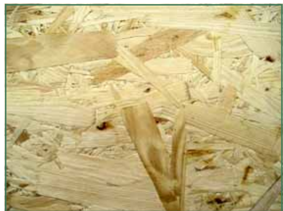
In de meeste houtskeletbouwen wordt een OSB (Oriented Strand Board) gebruikt als uitstijving en luchtdichting.
